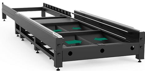
Станина выполнена из 8-миллиметровой высокопрочной стальной трубы, конструкция вставной станины, использует 3 процесса сварки. Затем она подвергается естественному старению и отжигу для снятия внутренних напряжений, так что слой сохраняет хорошие механические свойства с хорошими характеристиками прочности на растяжение и ударной вязкости.
