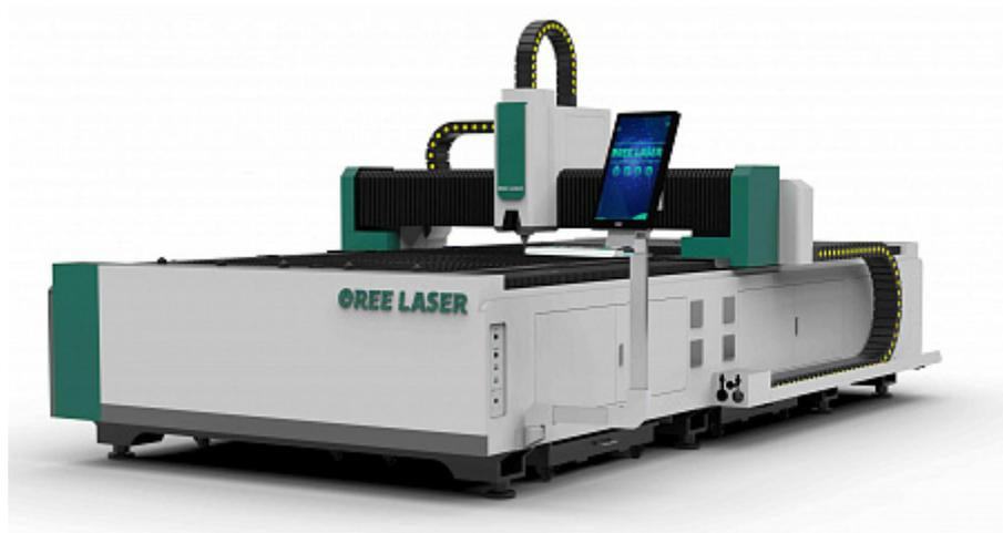
Основное применение лазерных станков OR-F для резки, гравировки, пробивки отверстий в листовом металле с высокой точностью и качеством обработки по контуру: нержавеющей стали, углеродистой стали, легированной стали, меди, алюминия, золота, серебра, титана и другого металлического листа.
