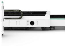
Лазер для резки металла со сменными столами имеет до двух раз более высокую производительность, по сравнению с моделями с фиксированным столом. Процесс смены столов занимает всего 10-15 секунд.
