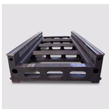
**В основе станков** — тяжелая сварная станина, выполненная из труб и профилей, листового металла особого сечения методом сверхточного компьютерного моделирования пространственных структур, что позволяет получить высочайшую жесткость при повышенной вязкости. В результате такая конструкция обеспечивает лучшие динамические показатели работы станка, по сравнению с традиционными решениями.
