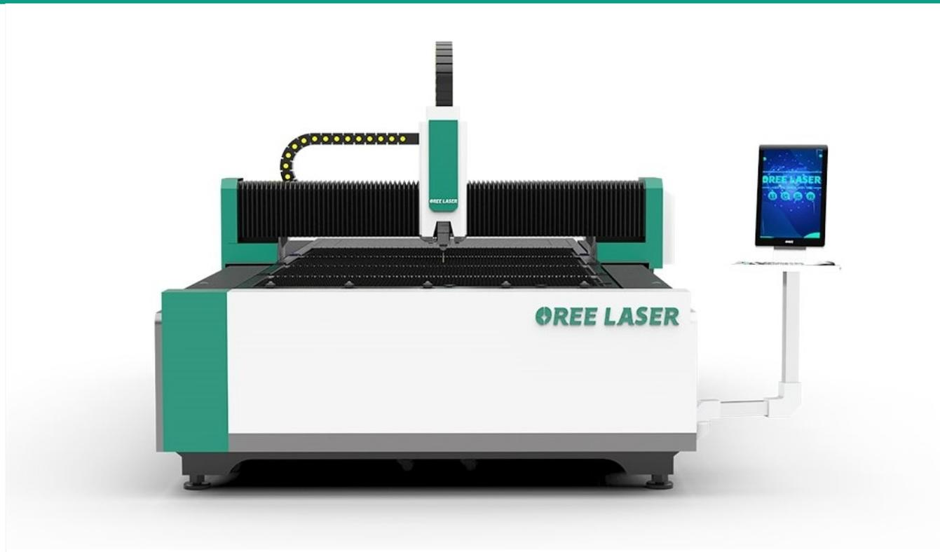
Иттербиевый оптоволоконный лазер OREE FMA3015 используется при контурной обработке различных типов сплавов, таких как черная углеродистая сталь, алюминий, медь, латунь.
