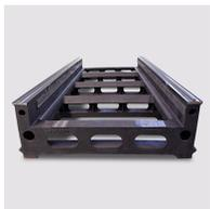
**В основе станков** — сварная станина, выполненная из труб и профилей особого сечения методом сверхточного компьютерного моделирования пространственных структур, что позволяет получить высочайшую жесткость при повышенной вязкости. В результате такая конструкция обеспечивает лучшие динамические показатели работы станка, по сравнению с традиционными решениями.
